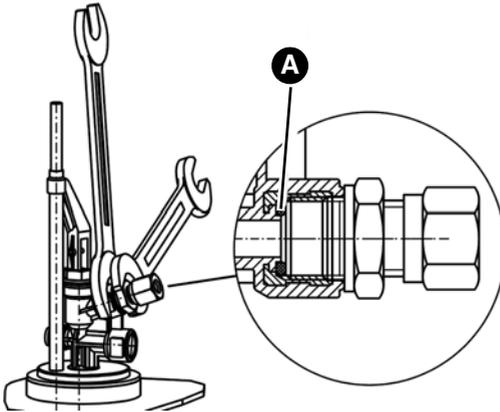
1. Legen Sie den O-Ring  $\text{\O} 9 \times 3 \text{ mm}$  (A) in das Anschlussstück ein.
