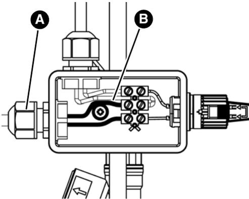
3. Schließen Sie die isolierte Litze (B) (braun oder schwarz) des Kabels an eine der beiden freien Klemme an.
