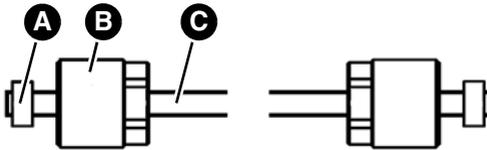
8. Schieben Sie die Überwurfmutter (B) und Dicht-
