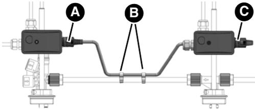
1. Ziehen Sie den Endabschlussstecker (C) vom Produkt ab und montieren Sie diesen an der letzten Erweiterung.
