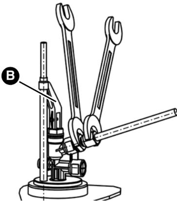
4. Führen Sie das Rohr in Verschraubung ein.
